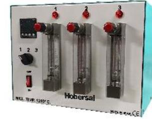
Caja de caudalímetros 1 Caudalímetros con electro válvulas y control digital
