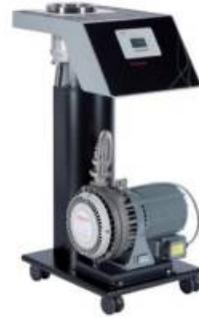
Bombas de vacío hasta  $\times 10^{-5}$  Mbar (bomba principal + bomba turbo Leybold)
