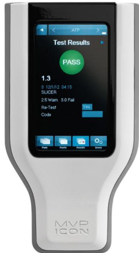
Esto permite al MVP ICON determinar instantáneamente si una superficie está suficientemente limpia o si está sucia y debe ser limpiada nuevamente para evitar la posible contaminación del producto.
