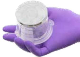
**Sencilla transferencia del embudo a la bomba:** un soporte integrado protege la membrana de la contaminación secundaria; no se necesitan pinzas.
