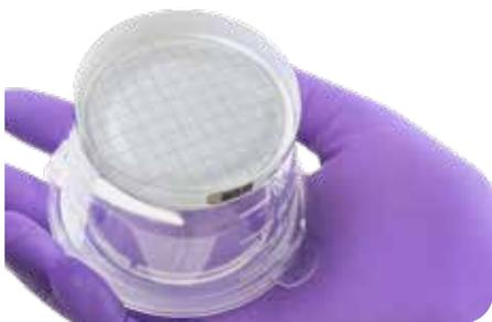
**Transferencia óptima, sin contacto, de la membrana a los medios de cultivo:** el diseño "sin contacto" consiste en una membrana sellada convexa que evita la formación de burbujas o que el analista enrolle los filtros.
