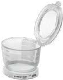
**Protección de la muestra:** la tapa abatible del embudo protege la muestra y reduce el número de etapas de manipulación.
