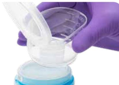
**Separación fácil del embudo:** basta con apretar ligeramente y el embudo se separa de la membrana. El plástico no se rompe. La tapa del embudo cierra la placa que contiene los medios, lista ya para incubación.
