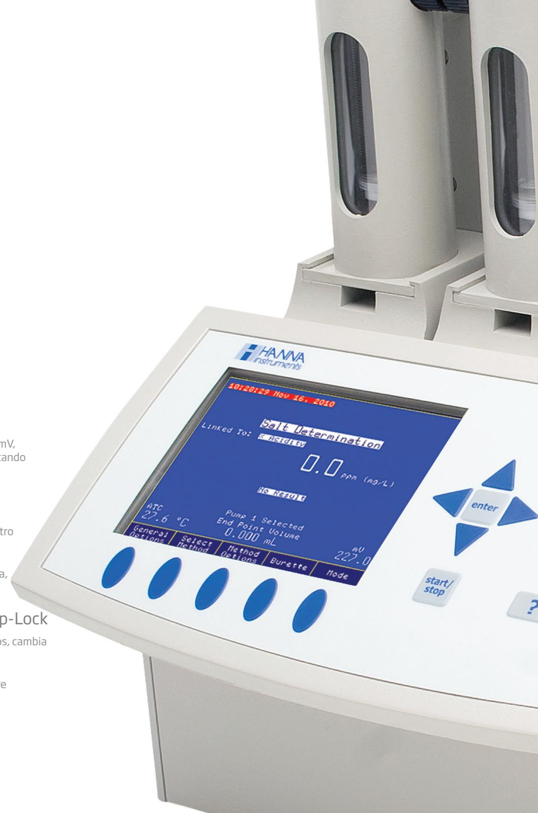
Evita la contaminación cruzada mediante el sistema inteligente de cambio de buretas.
