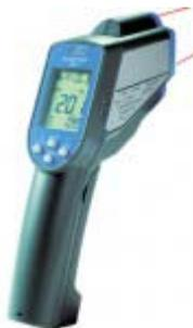
**SCANTEMP 490 – Termometro Infrarrojo con láser -60+1000°C TFA****Sensor:** 1 infrarrojo, 1 entrada sonda termopar K**Rango infrarrojo:** -60+1000°C**Rango con sonda termopar tipo K:** -64+1370°C**Resolución:** 0,1° C**Precisión:** ±2°C o ±2 % con infrarrojo, ±1% con termopar.**Puntero laser:** Clase II de precisión con doble haz**Tiempo de respuesta:** 1 seg. **Emisividad:** 0,1-1,00**Relación óptica:** 50:1 Pantalla iluminada.**Función:** Máx./ min., promedio y diferencial, alarma óptica
