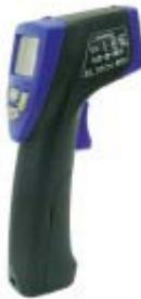
**RAY8875 – Termometro Infrarrojo con láser -40+500°C TFA****Rango:** -40 + 500: 0,1°C entre -40 + 100 °C, resto de escala :1°C, C/F**Resolución:** 0,1°C con infrarrojo**Precisión:** 2°C o ±2% entre -20 +200°C, resto de escala 3°C o ±3%.**Puntero láser:** Clase II**Tiempo de respuesta:** 500 ms.**Emisividad:** Ajustable de 0,3 a 1**Relación óptica:** 10:1**Temperatura de trabajo:** 0 + 50°C
