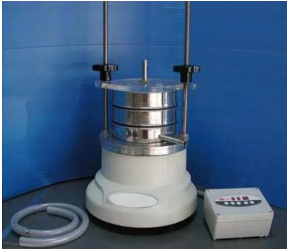
Las tamizadoras de laboratorio electromagnéticas digitales se utilizan para la separación de partículas en ensayos granulométricos a partir de 0.020 mm por vía húmeda.
