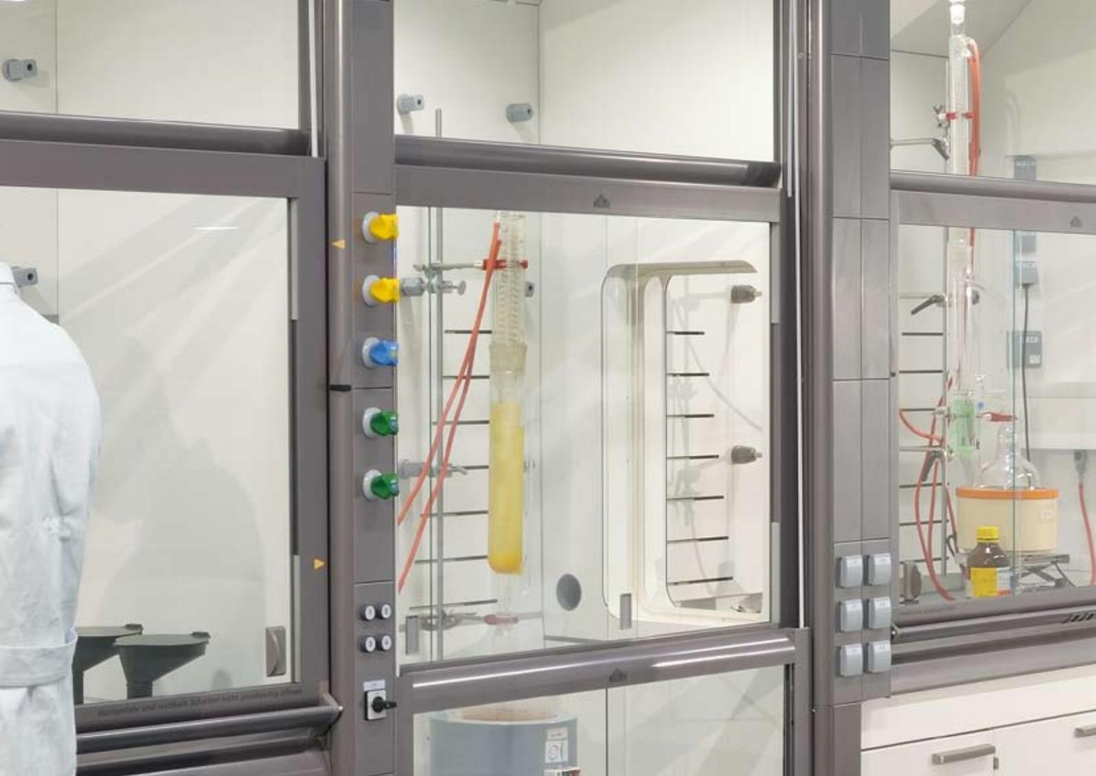
Nuestro nuevo Secuflow ofrece aún más seguridad con un gasto energético menor. Incluso si el despliegue del montaje experimental en el interior es importante o el movimiento por delante de la vitrina de gases es elevado, el Secuflow alcanza, con la guillotina abierta, unos excelentes valores de contención. Todo ello con unos caudales de extracción más reducidos y, por lo tanto, con un consumo energético significativamente más bajo.
