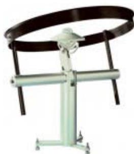
**DLPPYRA12 – Piranómetro clase primera según ISO9060** y siguiendo las recomendaciones del OMM para medir por separado la radiación global y la radiación difusa, mediante anillo de sombra.
