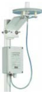
**DHD9408TBARO – Transmisor electrónico para la medición de la presión atmosférica** para aplicaciones meteorológicas y análisis ambientales.
