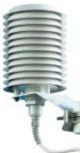
**DHD9008TR – Transmisor electrónico para la medición de la temperatura y humedad relativa del ambiente** para aplicaciones meteorológicas y análisis ambientales.
