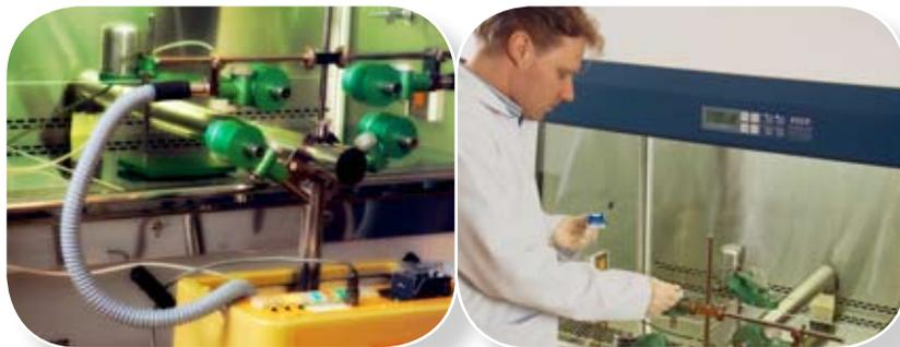
Cada modelo Airstream fabricado por Esco se ensaya individualmente, se documenta con un número de serie y se valida con los siguientes métodos de ensayo.
