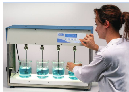
Floculador "Flocumatic" con elementos de iluminación en posición vertical. 6 plazas.
