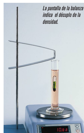
Previa a la inmersión del medidor, pulsar la tara a 0.
