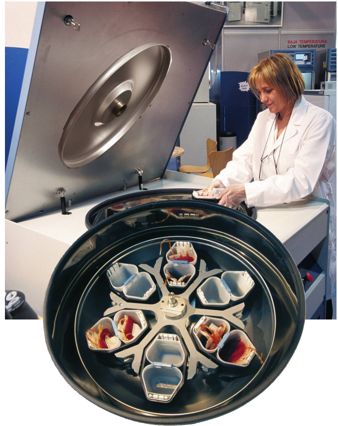
Imagen de la centrífuga con cabezal y vasos con doble compartimento para bolsas de sangre triples o cuádruples de 500 a 800 ml.
