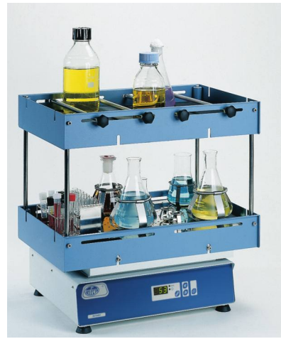
Plataforma doble código 3001011 adaptada al agitador código 3000974.
