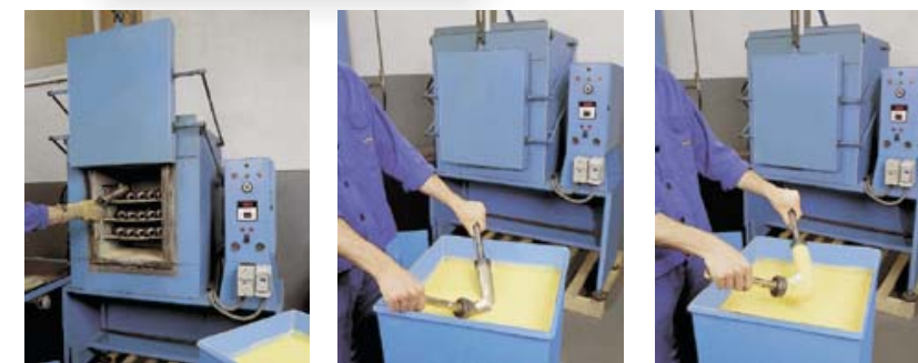
REVESTIMIENTO PLASTICO ANTICORROSIVO
