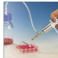
Aspiración con válvula en modo invertido
