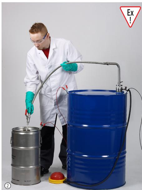
Bomba para disolventes con accionamiento de pedal para el trasiego de líquidos de gran pureza como p. ej. disolventes. Todas las piezas que entran en contacto con el medio están fabricadas en acero inoxidable (1.4301) y PTFE. Gracias a las abrazaderas de rosca y a la llave de paso, el recipiente y la bomba se cierran herméticamente.
