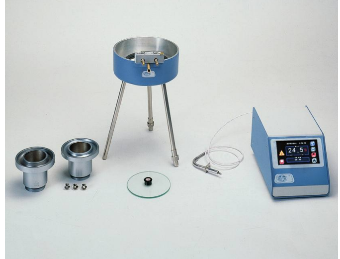
Copas para calefacción con rosca en la base para ser acopladas a baño maría y regulador de temperatura Electemp-TFT.
