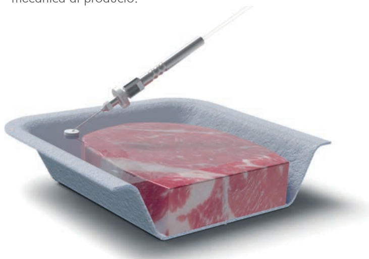
Extracción de una muestra de mezcla de gases protectores de un envase de alimentos
