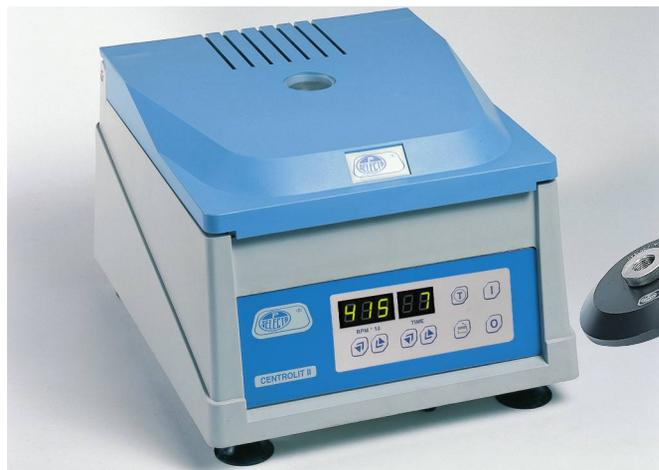
Mueble exterior moldeado en plástico técnico en ABS.
