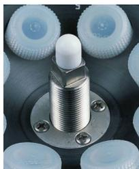
**Sensor de identificación de cabezal (solo en los modelos "Centronic BLT" y "Centrofriger BLT")**, que al cerrar la tapa de la cámara del rotor, comunica al microprocesador todos los límites de funcionamiento del cabezal, evitando así antes de la puesta en marcha cualquier riesgo de fallo en el momento de la programación de dichos parámetros. Este sistema es un método abierto de identificación que permite la posibilidad de ampliar la gama de cabezales en cada modelo de máquina.
