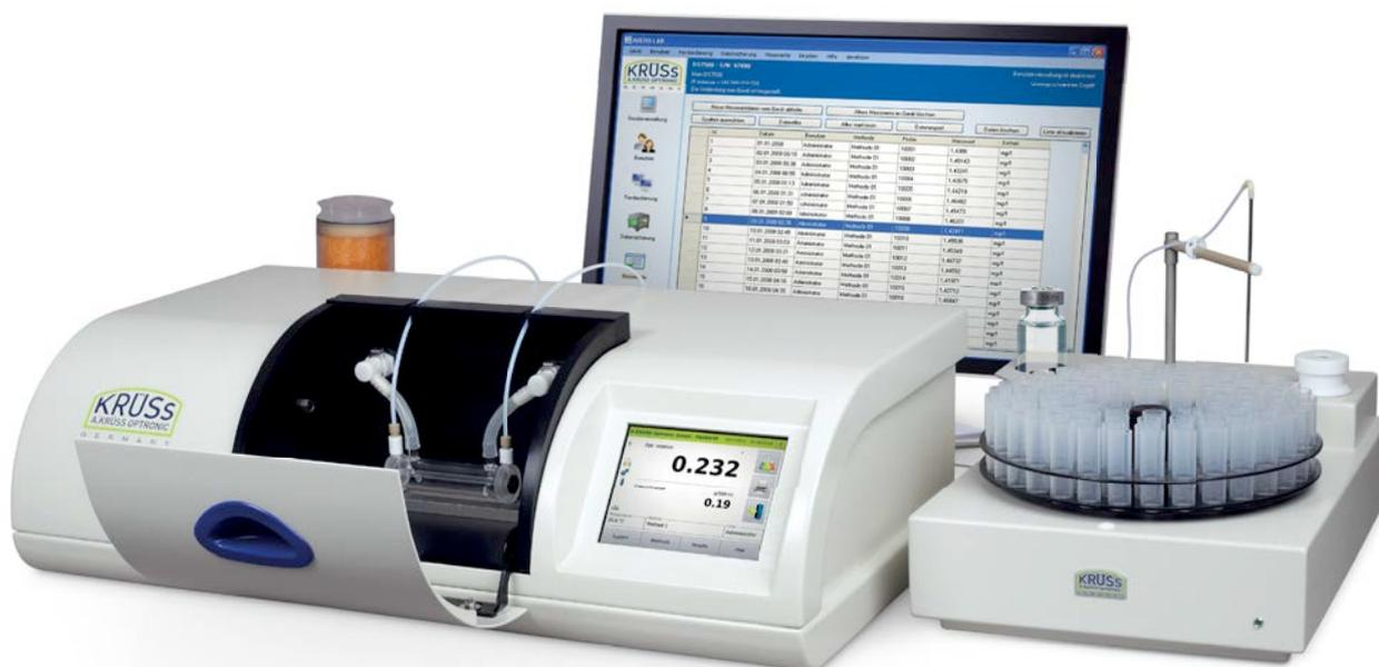
Inyección de muestras automática con P8000-TF, bomba peristáltica DS7070 y cargador de muestras AS90
