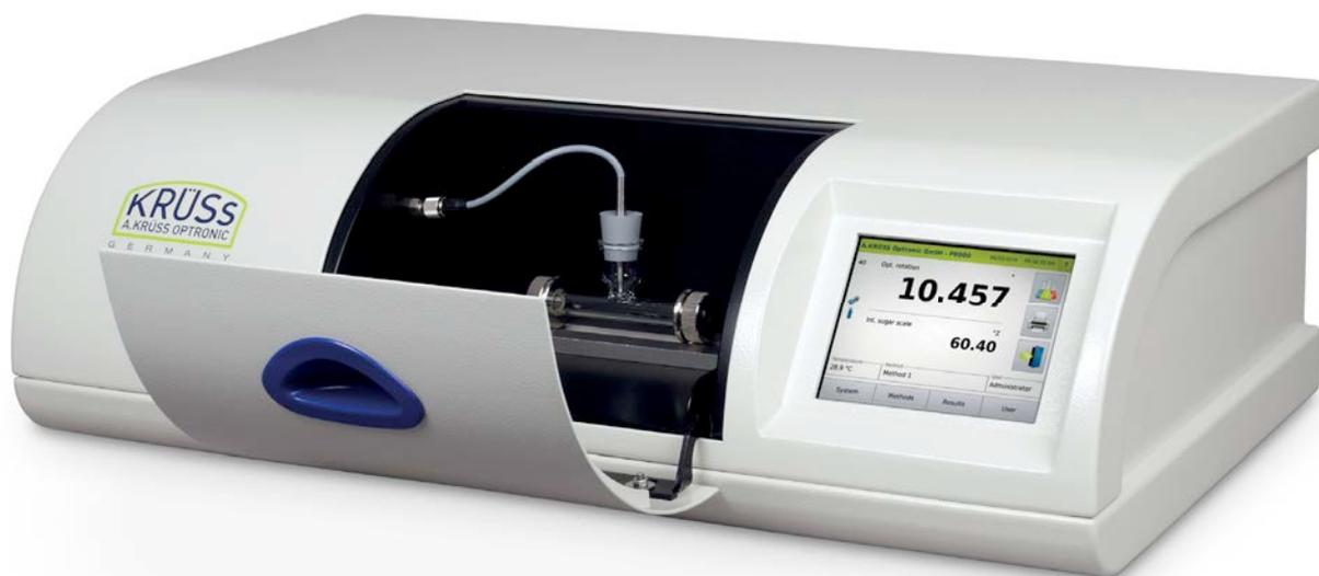
P8000 con tubo de medición PRG-100-E y sonda térmica PRT-E
