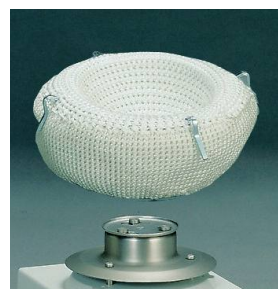
Agitador y manta con dispositivo adaptador.
