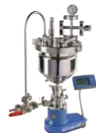
magic LAB® con módulo Micro-Plant 2 I para proceso en recirculación en recipiente cerrado
