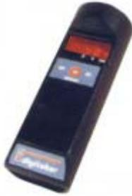
**9003.001 – Tacómetro digital portátil óptico**
