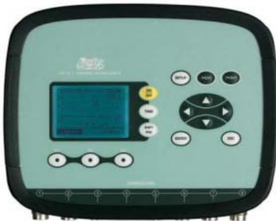
**DHD32.1 – Instrumento especialmente diseñado para el estudio, medición y control del microclima** en puestos de trabajo
