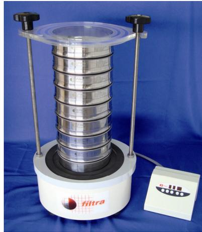
La tamizadora Digital Electromagnética se utiliza para ensayos granulométricos de separación de partículas de 0,040 mm en vía seca.
