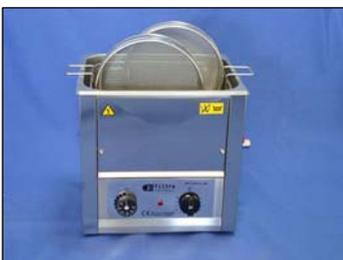
Baños de ultrasonidos para una limpieza óptima de tamices de ensayo y otros elementos de laboratorio.
