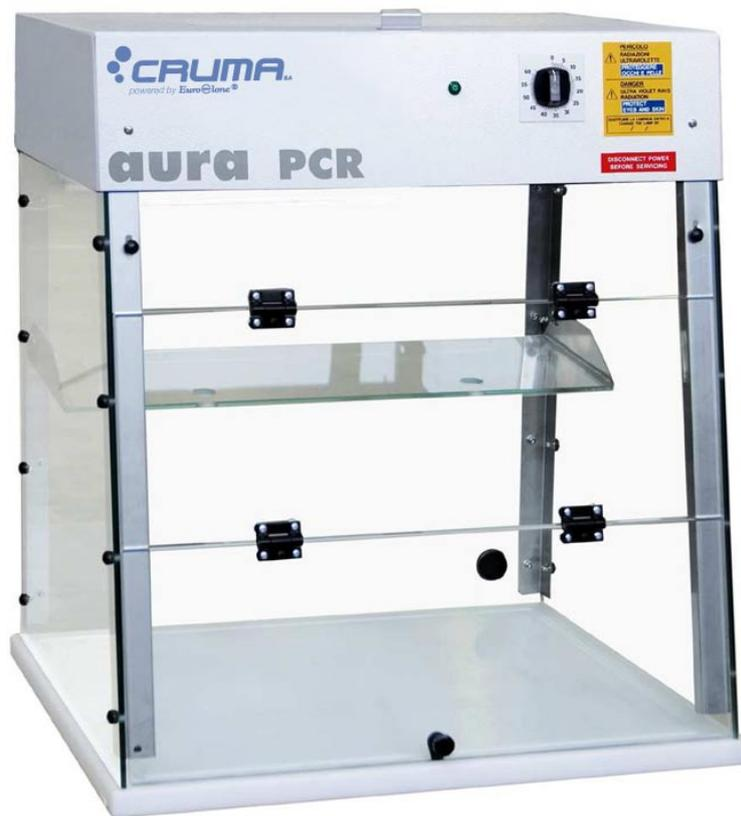
Cabina pasiva para PCR con lámparas UV apta para neutralizar el DNA en aerosoles, diseñada para la preparación de muestras de DNA en fase de preamplificación en ambiente controlado. Plano de trabajo en PVC fácil de limpiar, 3 lámparas UV, temporizador, lámpara de iluminación ínter bloqueada.
