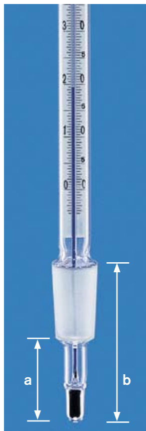
a: profundidad de inmersión b: longitud de montaje
