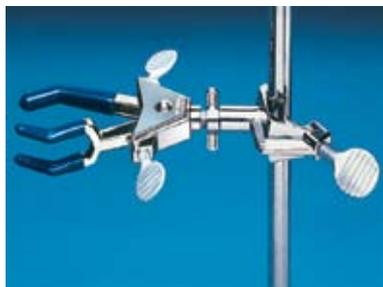
Aleación Castaloy®. Con dos brazos de sujeción de ajuste independiente para posicionado exacto del objeto. 2 versiones: ángulo de sujeción a elección 90° (fija) o giratoria 360° por rosca (prolongable hasta 5 mm máximo) y fijable. Tornillos de fijación en aluminio anodizado, muelle en acero inoxidable. Pinzas completas con manguitos de PVC y de fibra de vidrio. 1 unidad por embalaje.
