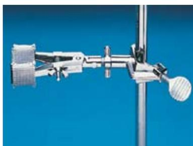
Aleación Castaloy®. Dos mordazas ligeramente curvadas sostienen los objetos cilíndricos, como por ej. tubos de ensayo, matraces o refrigerantes. 2 versiones: ángulo de sujeción a elección 90° (fija) o giratoria 360° por rosca (prolongable hasta 5 mm máximo) y fijable. Tornillos de fijación en aluminio anodizado, muelle en acero inoxidable. Pinzas completas con manguitos de PVC y de fibra de vidrio. 1 unidad por embalaje.
