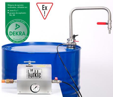
El sistema de extracción de disolventes permite trasegar de forma rápida y sencilla líquidos de gran pureza. Utilizando gas comprimido (aire comprimido o nitrógeno), se genera una sobrepresión en el interior del recipiente, la cual hace salir el líquido. Como resultado, se pueden trasegar sustancias peligrosas con seguridad y también dosificar con precisión utilizando la llave de paso. Al manipular sustancias de gran pureza o sensibles al oxígeno, puede utilizarse
