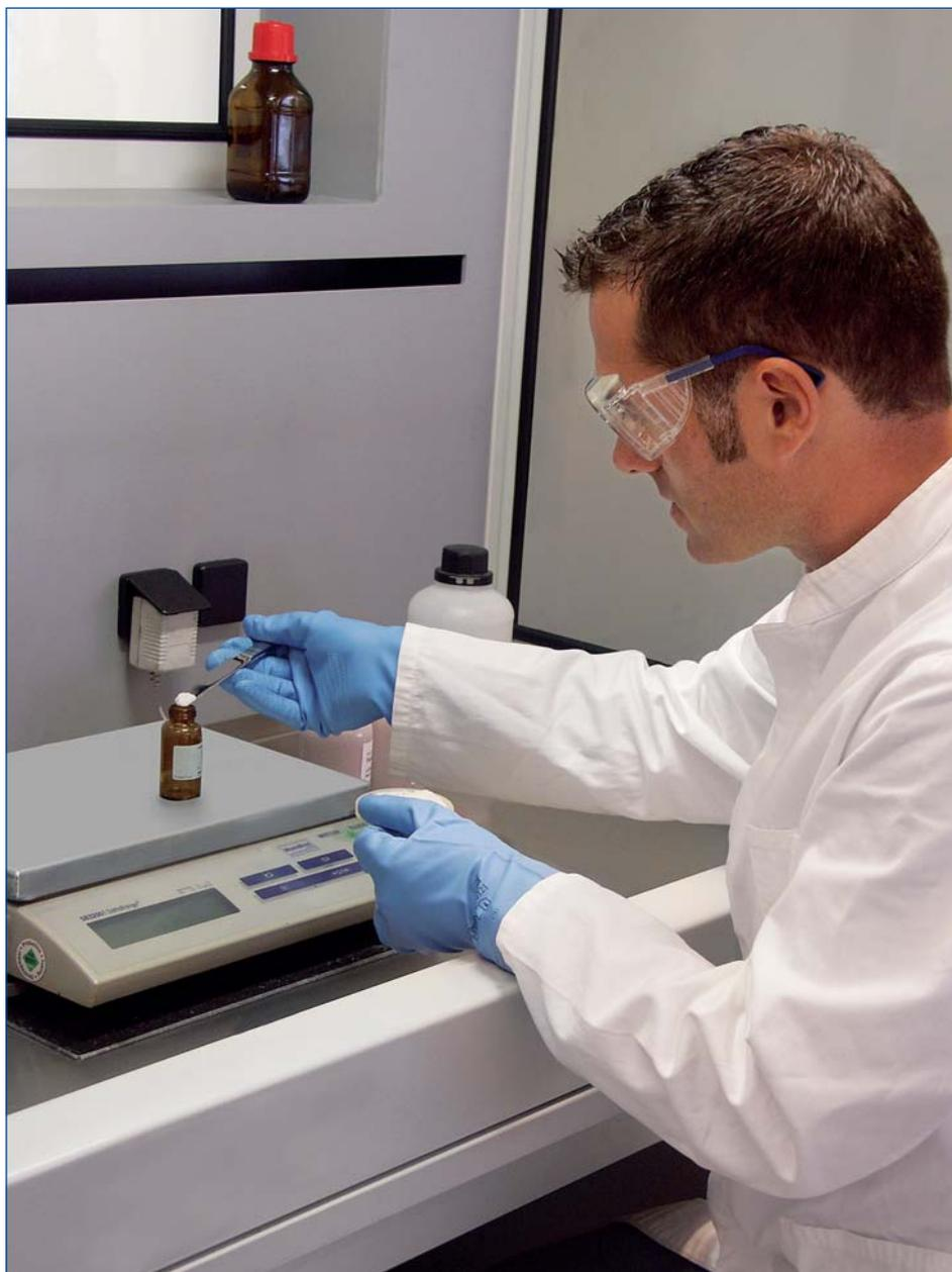
**Seguridad en el pesaje y corte de las preparaciones en las campanas de aspiración/ pesaje para sustancias peligrosas**
