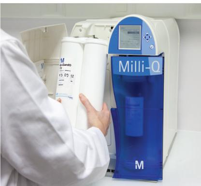
Sustitución del módulo de ultra-purificación Q-Pak®
