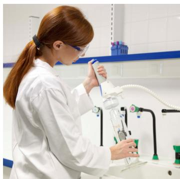
El tubo de 75 cm de longitud puede llevarse hasta la pila para enjuagar con facilidad el material de vidrio a un caudal medio o elevado (hasta 2 litros por minuto).
