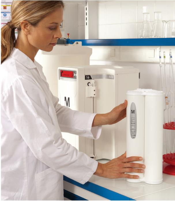
Los robustos **sistemas RiOs™ Essential** de Merck Millipore han sido desarrollados para asegurar una producción fiable y constante de agua de tipo III. Estos robustos sistemas incorporan técnicas de purificación de agua complementarias, como **pretratamiento** y membranas de ósmosis inversa **de gran rendimiento**.
